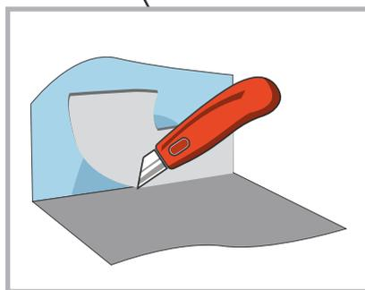
Обрезаем излишки ТермоЗвукоИзола и желателно заполняем пространство виброакустическим герметиком Сонетик.
