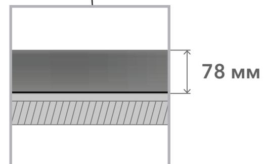
Укладываем стальную сетку для армирования стяжки. В случае использования полусухой стяжки армирование стальной сеткой не требуется.
